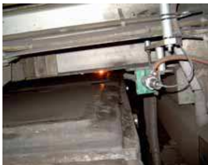
利用光纤探头在狭窄空间内进行测量
